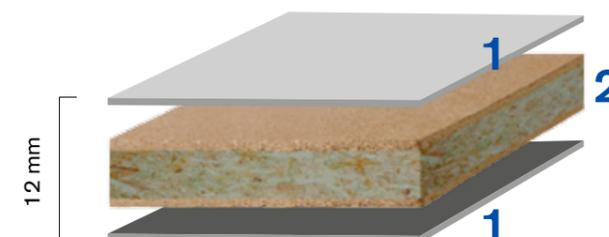
**0.9 mm** spessore del laminato utilizzato in SMART
